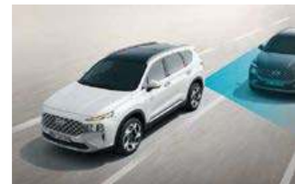
Blind-Spot Collision-Avoidance Assist (BCA) Χρησιμοποιώντας αισθητήρες ραντάρ στο κάτω τμήμα του πίσω προφυλακτήρα και μια εμπρόσθια κάμερα, το σύστημα αυτό σας προειδοποιεί για τυχόν κυκλοφορία στο τυφλό σημείο. Εάν ενεργοποιήσετε το φλας σε μια τέτοια περίπτωση, θα ακουστεί ένα προειδοποιητικό σήμα και το σύστημα θα φρενάρι ώστε να αποφευχθεί η σύγκρουση.
