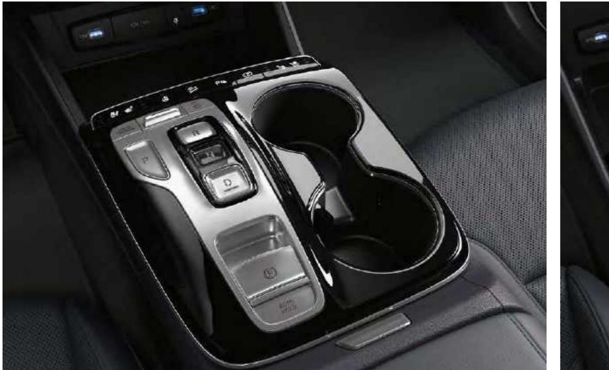
Αυτόματο κιβώτιο με πλήκτρα (shift-by-wire).
