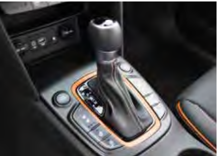
Αυτόματο κιβώτιο 7 σχέσεων διπλού συμπλέκτη (7-DCT)
