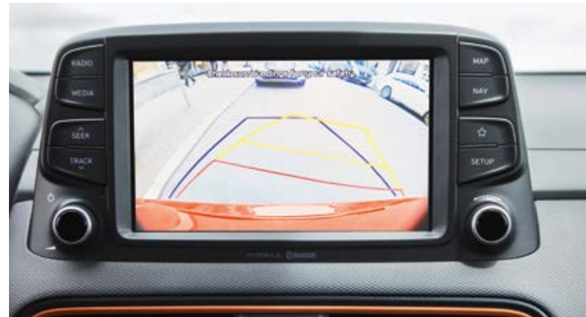
Κάμερα οπισθοπορείας με δυναμικές γραμμές καθοδήγησης
