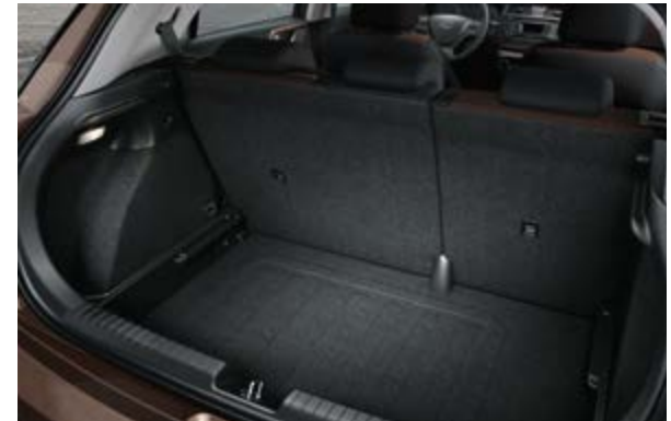
Ρυθμιζόμενο δάπεδο χώρου αποσκευών. Το δάπεδο του χώρου αποσκευών μπορεί να τοποθετηθεί σε 2 διαφορετικά ύψη δημιουργώντας είτε ένα επίπεδο δάπεδο, με τα καθίσματα πλήρως αναδιπλωμένα, είτε χώρο αποσκευών με μεγαλύτερο βάθος, ανάλογα με τις προτιμήσεις σας.
