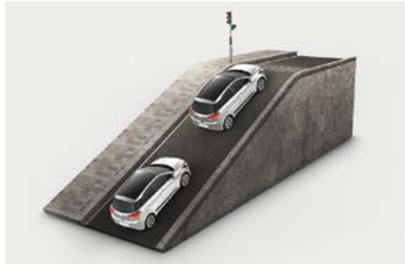
Σύστημα υποβοήθησης εκκίνησης σε ανηφόρα. Δεν αφήνει το αυτοκίνητο να κυλήσει προς τα πίσω κατά την εκκίνηση σε ανηφόρα. (Standard σε όλες τις εκδόσεις)
