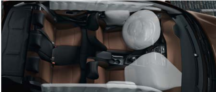
6 αερόσακοι. Απόλυτη προστασία με 6 αερόσακους: 2 μετωπικούς, 2 πλευρικούς και 2 τύπου κουρτίνας. (Standard σε όλες τις εκδόσεις)
